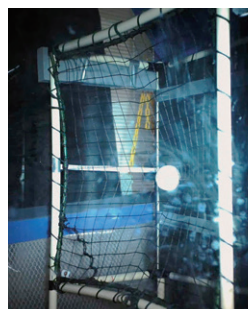
硬式ボールでの衝突耐久実験
